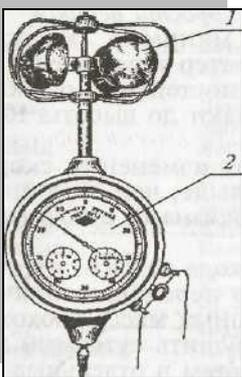
Применяется для определения скорости ветра (измеряет скорость ветра от 1 до 20 м/с).
