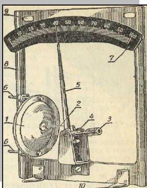
Гигрометр, который служит для определения относительной влажности воздуха, приемником является мембрана из гигроскопической животной пленки
